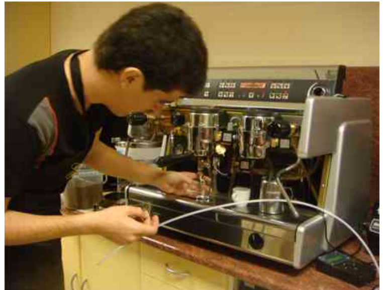
Moments de la instal·lació de la conducció del CO 2 cap al grup de la màquina.
